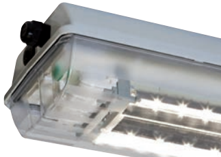
LED-Leuchte in der Zündschutzart „e“ im Schutzniveau „eb“ mit LEDs in der Zündschutzart „m“.
