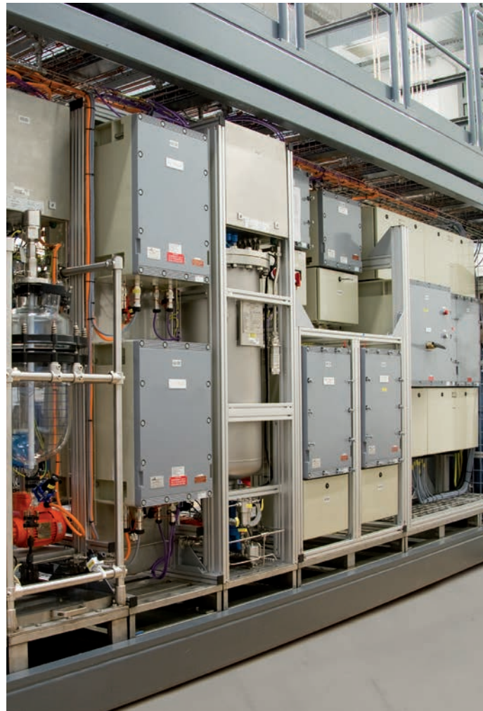
Anwendungsbeispiel: Ex-d Gehäuselösungen in der Chemischen Industrie
