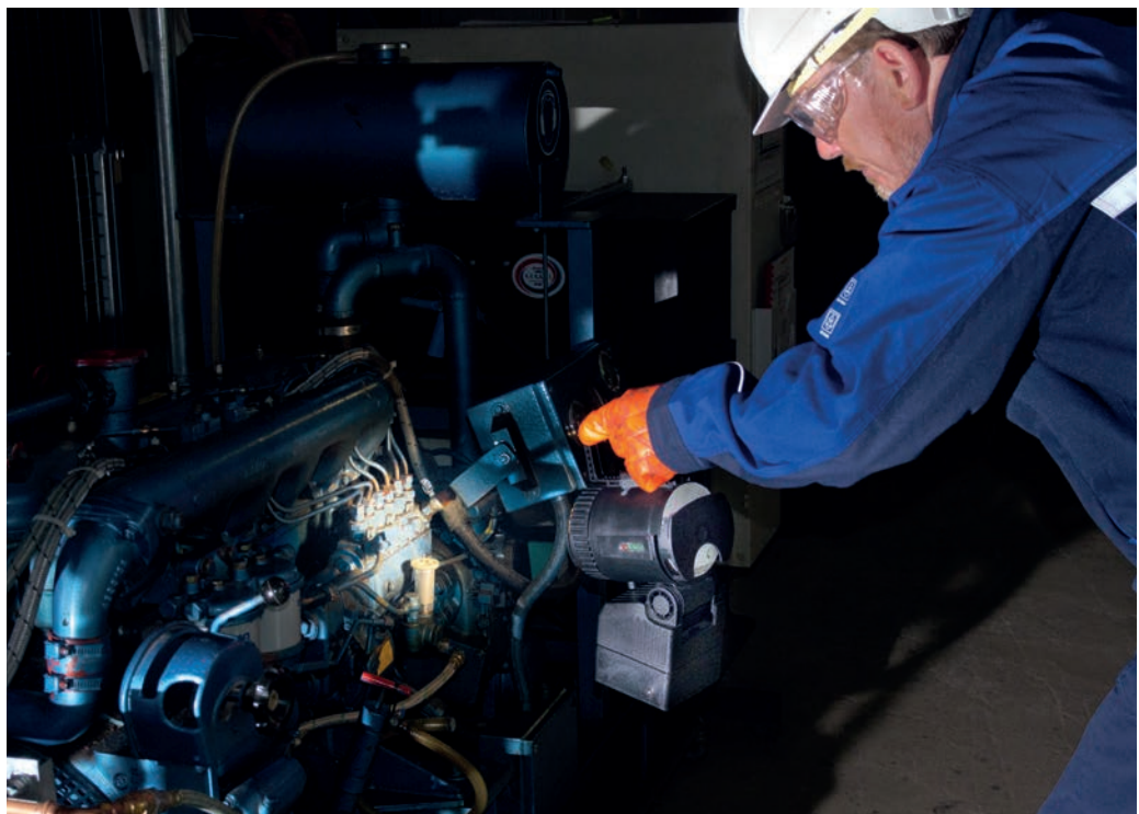
Explosionsschutzgeschützte Handleuchten sorgen bei Inspektions- und Wartungsarbeiten für die flexible und sichere Ausleuchtung des Arbeitsfeldes
