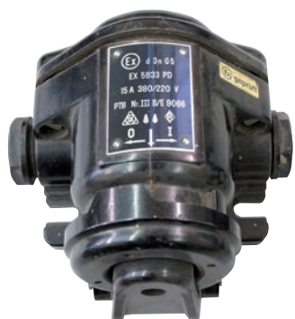
Explosionsschutz elektrische Geräte aus den 1960er Jahren
